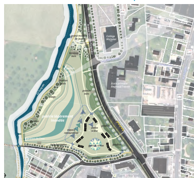
SCÉNARIO CRUE / La prairie est totalement inondée en cas de crue et sert de bassin d'expansion de crue
