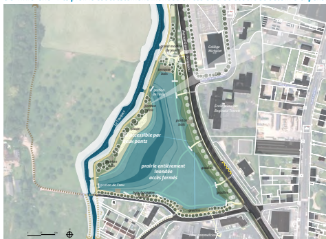
SCÉNARIO CRUE / La prairie est totalement inondée en cas de crue et sert de bassin d'expansion de crue
