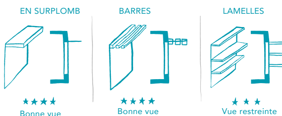
Exemples de types de dispositifs d'ombrage extérieurs spécifiquement destinés aux fenêtres orientées vers le sud. S'ils peuvent être mobiles, ils peuvent répondre aux variations quotidiennes imprévisibles. © Crédit image : Peter Barrett, Yufan Zhang, Fay Davies, Lucinda Barrett, 2015, Rapport de synthèse clever classroom
