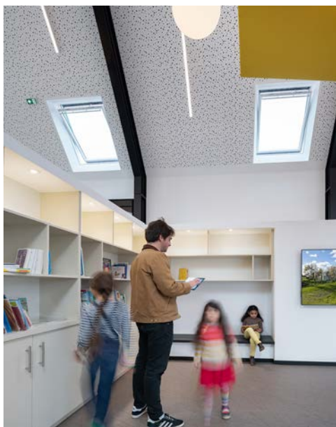
Velux motorisés pour optimiser la qualité de l'air intérieur Groupe scolaire "Les 3 Chênes" à Auvers (50) Agence d'Architecture Camelia Alex Letenieur © Crédit photo : Guillaume Jouet
