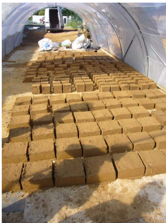
Séchage des briques en terre cuite Pôle enfance Félix Leclerc à Bouvron (44) Agence d'Architecture Belenfant Daubas © Crédit photo : Loïc Daubas
