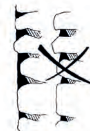
L'enduit est beurré au niveau moyen des parements
