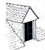
Lucarne à bâtière
