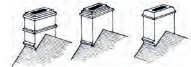
Trois exemples de souches de cheminées.
