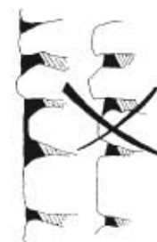
» L'enduit est beurré au niveau moyen des parements
