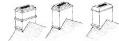
Trois exemples de souches de cheminées.
