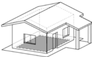
Surface de plancher
